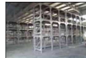
金型倉庫の棚 SS400 ■総重量: 76900kg
