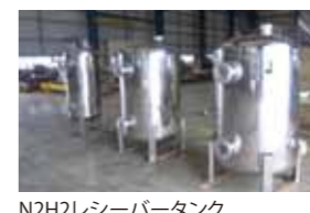
N2H2レシーバータンク SUS304 ■1 m 3 ~ 2 台、0.5 m 3 ~ 1 台
