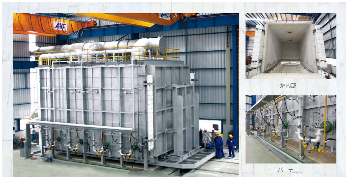
台車式対流型熱処理炉 閉口時
