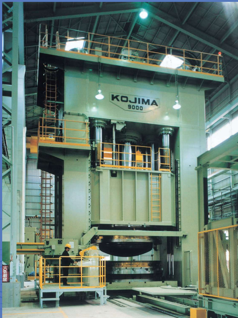
9000ton プレス「関東工場」
