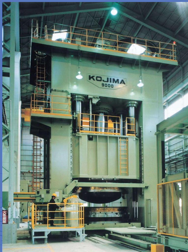
9000ton プレス「関東工場」
