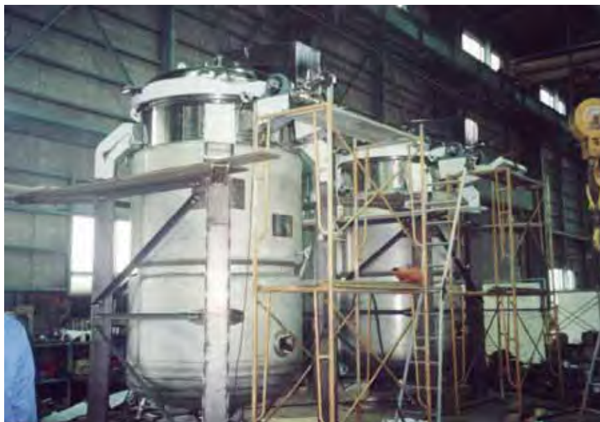
9 m 3 加圧抽出釜 第1種圧力容器 平成13年7月完成
