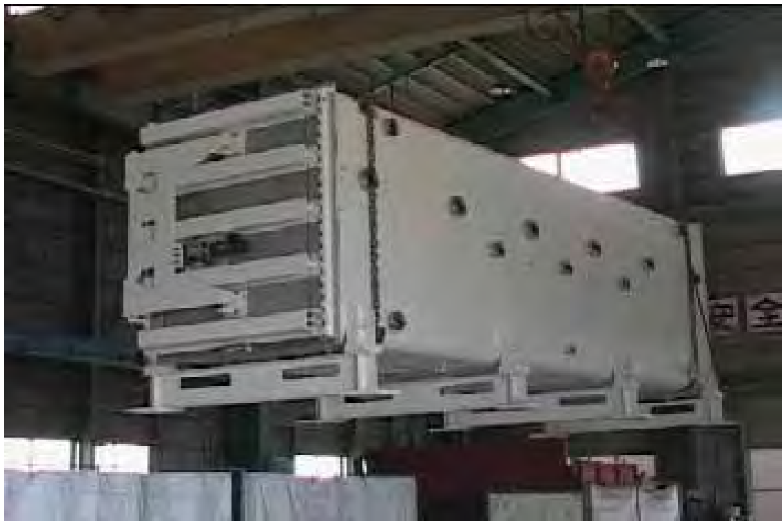
高圧蒸気滅菌装置用缶体 ( 本体部 S U S 3 0 4 )
