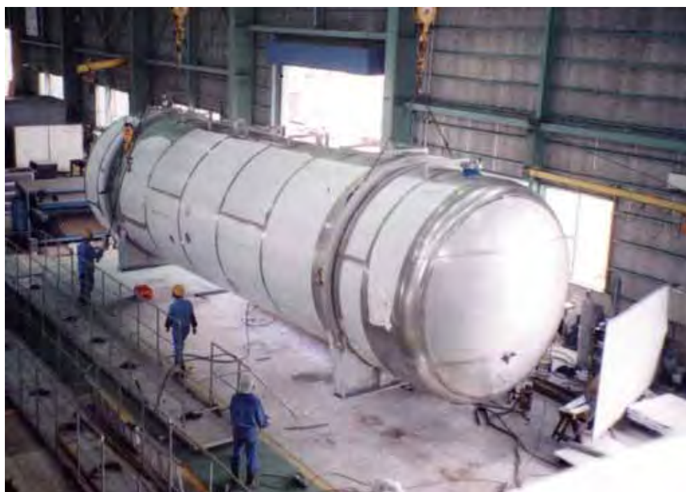
100 m 3 仕込み水タンク 平成11年8月完成
