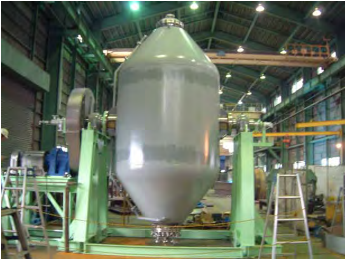
コニカルブレンダードライヤ ( 第一種圧力容器 本体SUS304 厚さ2.8mm )
